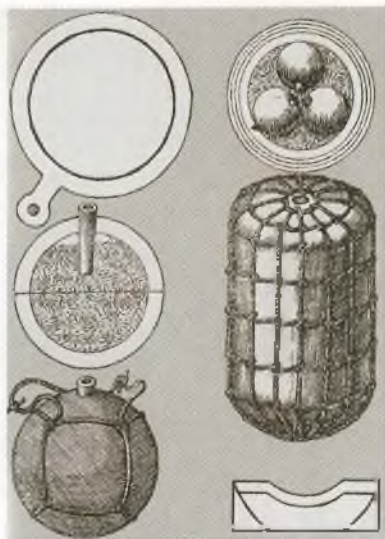
Разные типы снарядов, употребляемые во флоте в конце XVIII века.
