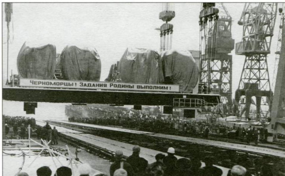
4 декабря 1985 г.: через несколько минут после спуска заказа № 105 («Леонид Брежнев») проходит эффектная закладка на стапель днищевой секции с первым эшелон паросиловой установки заказа № 106 («Рига»)
